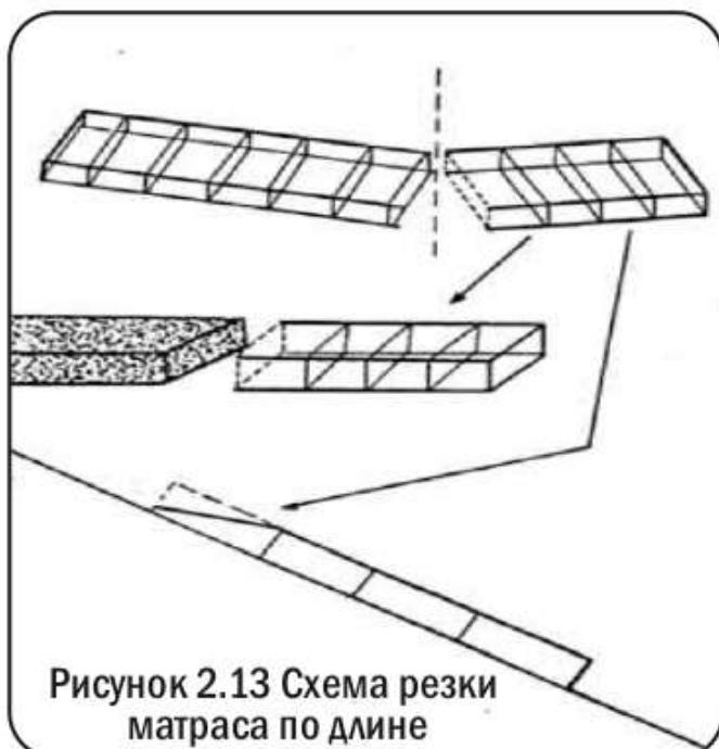
Рисунок 2.13 Схема резки матраса по длине
