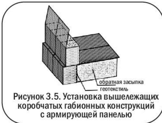
Рисунок 3.5. Установка вышележащих коробчатых габионных конструкций с армирующей панелью
