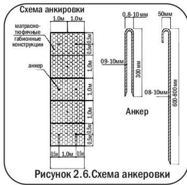
Рисунок 2.6.Схема анкеровки
