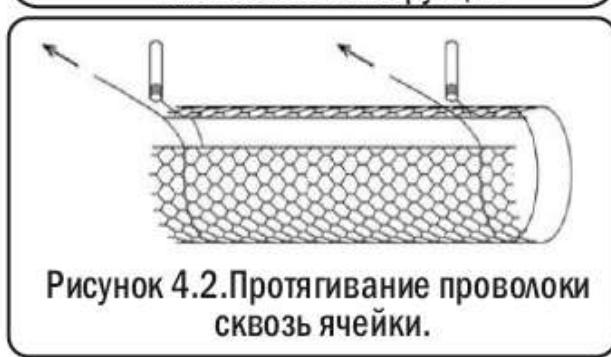
Рисунок 4.2. Протягивание проволоки сквозь ячейки.
