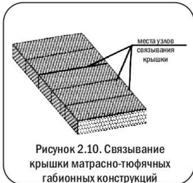
При наличии нескольких уже заполненных матрасных конструкций, уложенных по откосу, установка крышек может осуществляться укладкой поверх них рулона сетки двойного кручения шириной 2,0 м и длиной, равной сумме длин закрываемых матрасов (рис. 2.9 и рис. 2.10).
