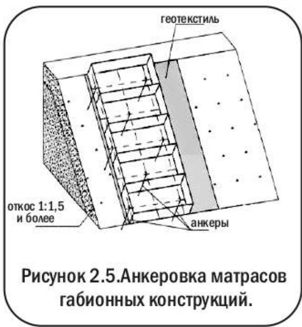
Рисунок 2.5.Анкеровка матрасов габионных конструкций.
