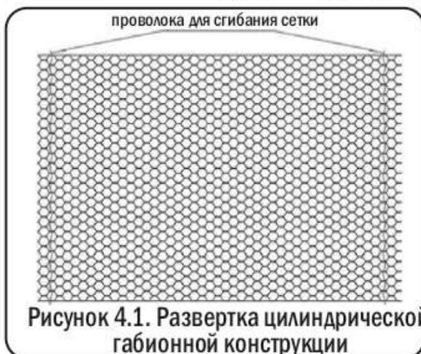
Рисунок 4.1. Развертка цилиндрической габионной конструкции
